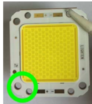
使用塑膠鑷子拿取 Use plastic tweezers
