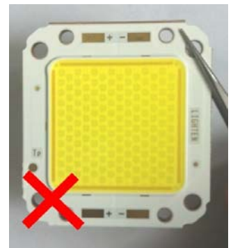
不可使用鐵製鑷子 Don't use iron tweezers
