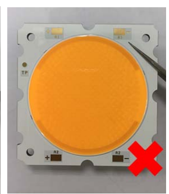
不可使用鐵製鑷子 Don't use iron tweezers
