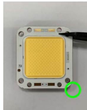
使用塑膠鑷子拿取 Use plastic tweezers
